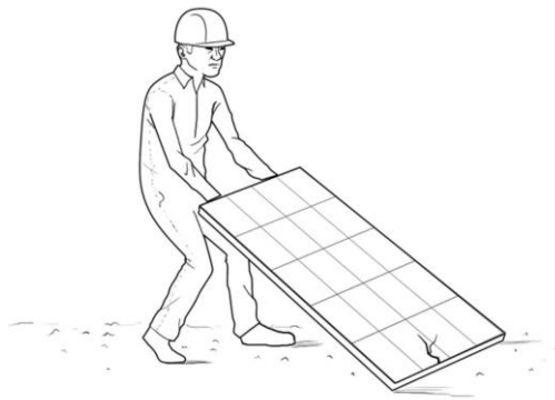
รูปที่ 108 การขนส่งและการติดตั้งที่ไม่เหมาะสมอาจทำให้โมดูลเสียหาย
