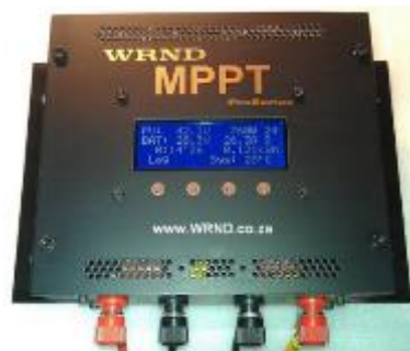
รูปที่ 35 ตัวควบคุมการติดตามกำลังสูงสุด
