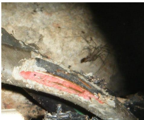
รูปที่ 188 รอยจากการกัดของสัตว์ฟันแทะ
