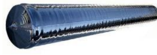
รูปที่ 17 ผลึกเดี่ยวของซิลิกอนบริสุทธิ์
