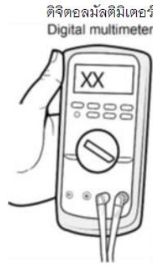
รูปที่ 87 การประเมินความต้องการพลังงานด้วยการวัดแรงดันและกระแสโดยตรงโดยใช้มัลติมิเตอร์
