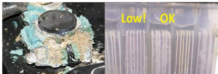
รูปที่ 177 ขั้วแบตเตอรี่สีกร่อน (ซ้าย) ระดับสารละลายอิเล็กโทรไลต์(ขวา)
