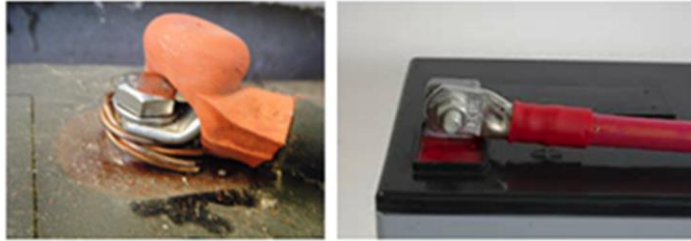
รูปที่ 103 การเชื่อมต่อไม่ดี (ซ้าย), การเชื่อมต่อที่ดี (ขวา) ที่บริเวณขั้วต่อของแบตเตอรี่
