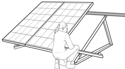
รูปที่ 165 ติดตั้งระบบยึดแผงเซลล์แสงอาทิตย์
