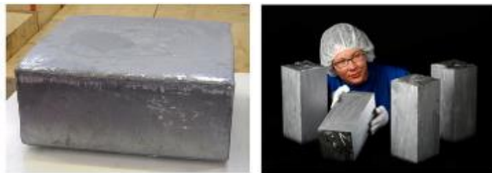
รูปที่ 21 ก้อนโพลีคริสตัลไลน์และการหล่อเป็นบล็อกสี่เหลี่ยม
