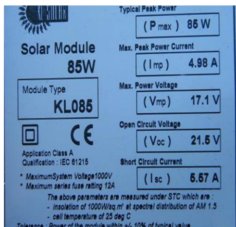
รูปที่ 43 ฉลากบนแผงเซลล์แสงอาทิตย์ 85 วัตต์สูงสุด (Wp)
